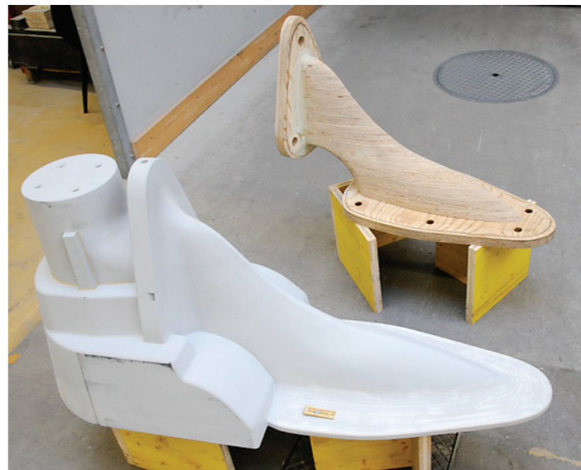
Entwicklung der Gussteile vom Modell zur Gussform
