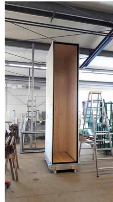
04.07.2019 Holzmodell M 1:1 zur genauen Festlegung der Montagepunkte für die Neonröhren
